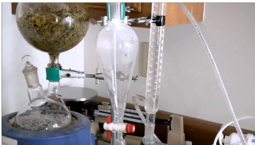
1.1.1. ábra. Illóolaj kinyerése desztillációval
