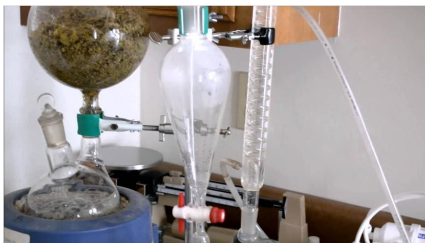
1.1.1. ábra. Illóolaj kinyerése desztillációval
