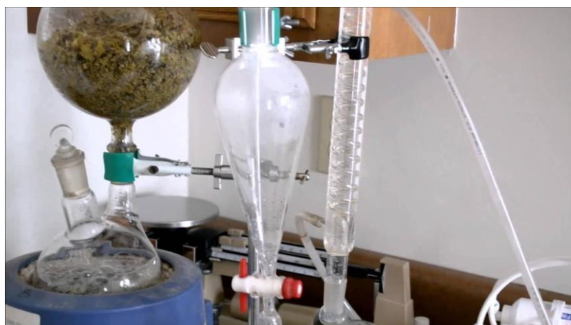
1.1.1. ábra. Illóolaj kinyerése desztillációval
