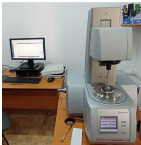
4.6. ábra. Anton Paar MCR 302 reométer
