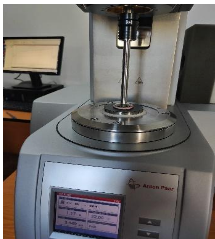
4.6. ábra. Anton Paar MCR 302 reométer
