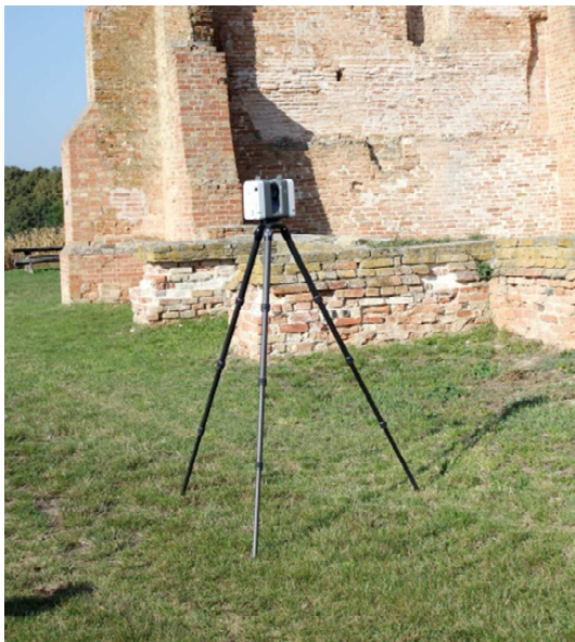
4-5. ábra Lézerszkennер és a használt illesztőpontok egyike
