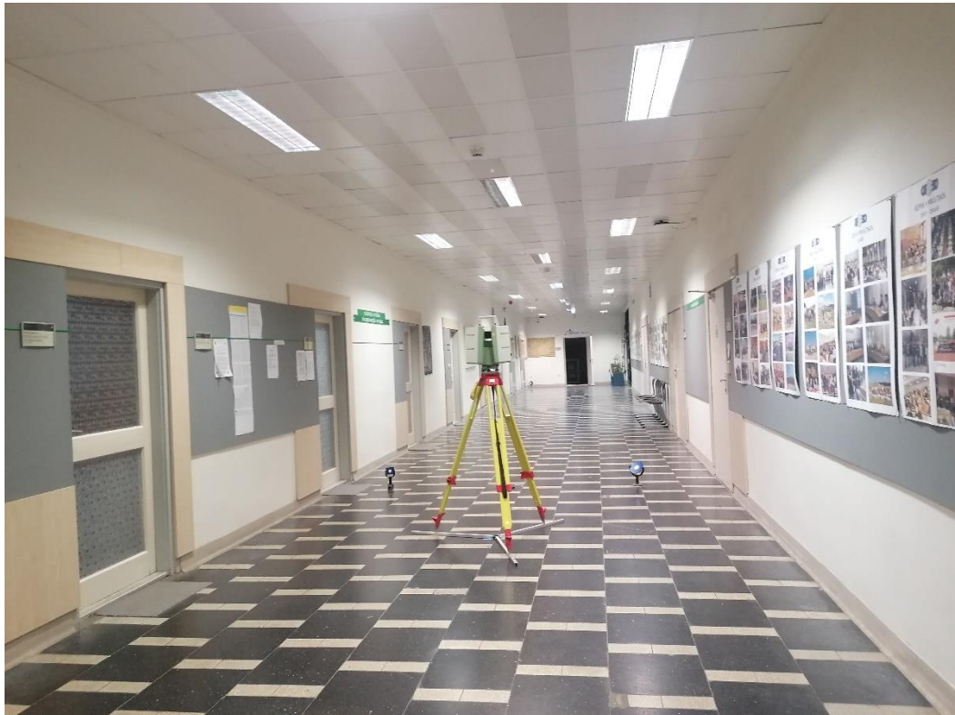
7. ábra - Leica ScanStation C10 lézerszkennner
