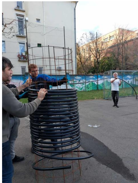
13. ábra Spirális hőcserélő készítés alatt (saját kép)
