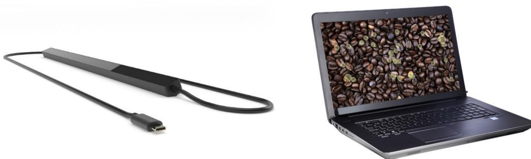
2. ábra: A Tobii Pro Fusion szemkamera önállóan (balra) és a laptopképernyőjének az aljához rögzítve (jobbra)
