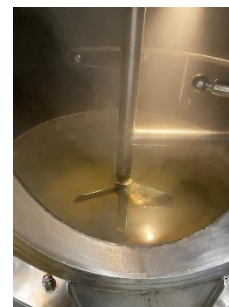
14. ábra: Keverő (Saját készítés)
