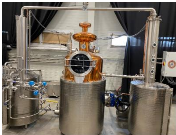
13. ábra: Hagyó lepárló berendezés (Saját készítés)
