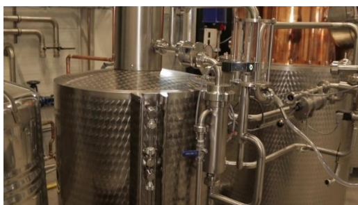
17. ábra: Elő- és utópárlat mérők, kozmaolaj szűrő, epruvetta, mintavevő készülék
