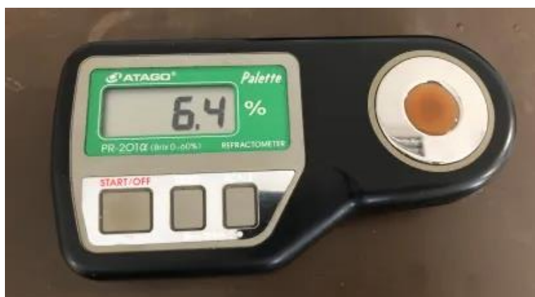
15. kép: °Brix tartalom mérés. (Forrás: Saját fénykép)
