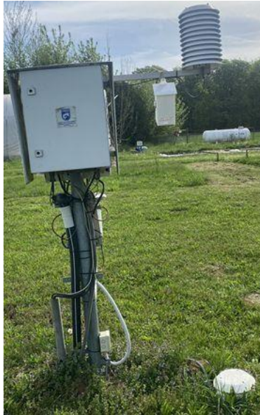
29. ábra: (SAJÁT) OMSZ által üzemeltetett QLC 50 típusú klíma állomás és a saját műszerem.
