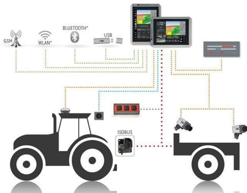
5. ábra: (http9) CANBUS és ISOBUS összeköttetésének szemléltetése.
