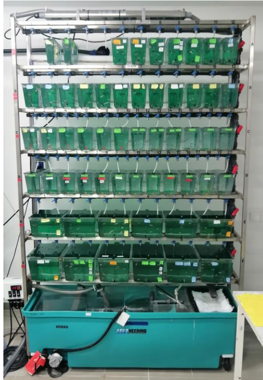
8. ábra: A recirkulációs haltartó rendszer. Ebben a moduláris haltartó rendszerben tartjuk a halakat, a különböző sorokon. A rendszer recirkulációs elven működik, a víz folyamatosan kering, miközben több szűrésen és tisztításon megy át mielőtt visszajut a tartályokba. (Fotók: saját)
