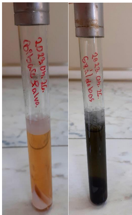
7. ábra: Clostridium sp. kimutatása (baloldali negatív, jobboldali pozitív minta) (Fotó: Salamon Tímea)
