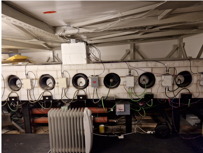
1.2. ábra. Saját készítésű kép a neutron detektorról 2023.08.04-én. A képen hat cső látható a nyolcból, illetve az őket körülvevő szigetelő réteg.
