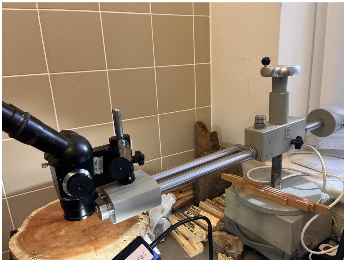
7. ábra: Sztereomikroszkóp és a LINTAB mérőasztal az ELTE TTK laboratóriumában (saját fotó)
