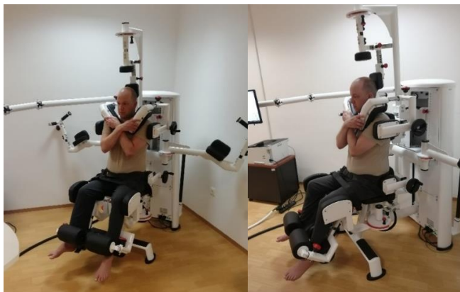
4. ábra: izometriai mérésre szolgáló berendezés, mérés közben (saját szerk.).
