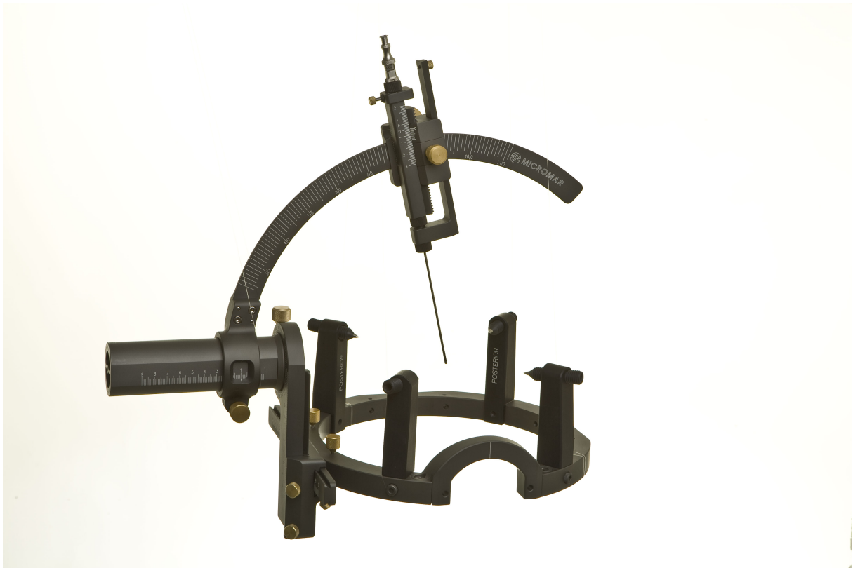
1. ábra. Példa sztereotaxiás keretre. Megfigyelhetők a három merőleges tengely és két ív menti beállítások.
