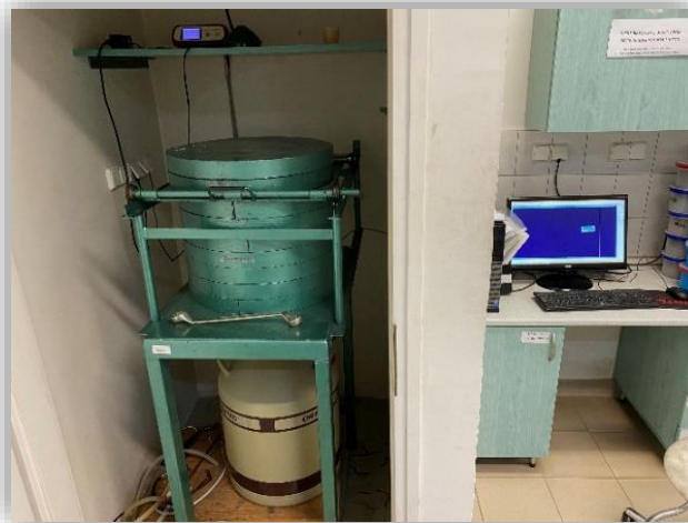
3.4. ábra: ORTEC HPGe-félvezető gamma-detektor
