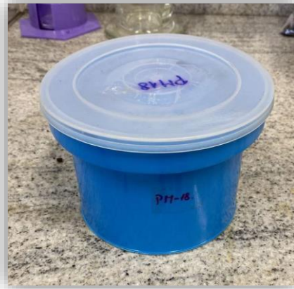
3.3. ábra: A gamma-spektrometriai mérésekhez használt Marinelli-mintatartó
