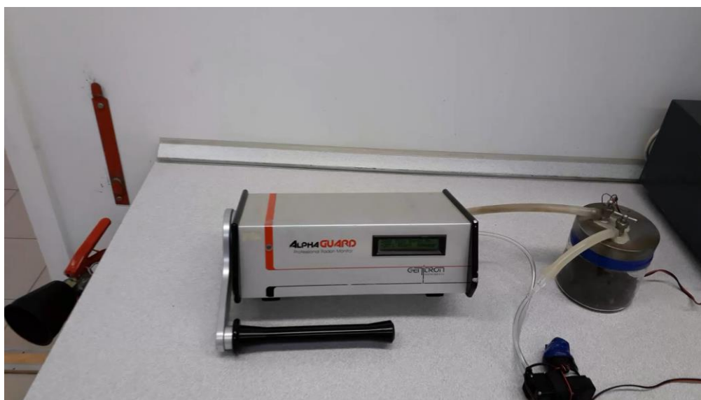
3.5. ábra: Az alkalmazott mérőrendszer az AlphaGUARD 2000 monitorral
