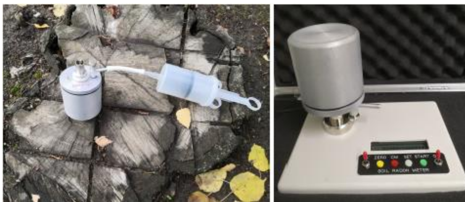
3.7. ábra: A mintavétel eszközei és a Soil Radon Monitoring System RM-2 eszköz [32]
