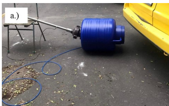
1. ábra a.) nagy térfogatú KÁLMÁN PM2.5 mintavevő egység és b.) kvarcszűrő 10 perces mintavétel után
