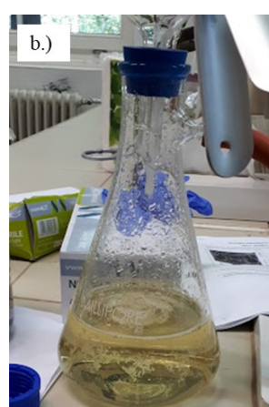
2. ábra Kivonat készítése a.) extrahálás nagy tisztaságú (Milli Q) vízben és b.) 0,45 \mu\text{m} pórusméretű szűrőn szűrés
