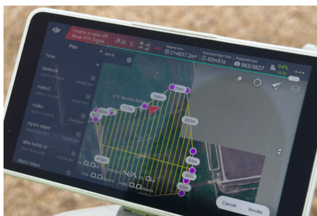
4. kép, RTK kapcsolati hiba (Tuza Attila)
