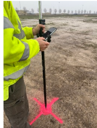
1. és 2. kép, GCP pontok kijelölése és bemérése (Tuza Attila)
