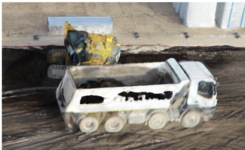
20. kép, Modell hibajelenség (Tuza Attila)
