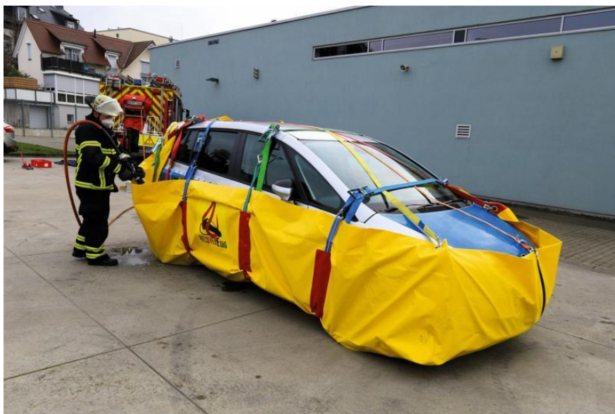
3.sz. kép: A Recover-E-Bag jó megoldás lehet helyszűke esetén, főleg mélygarázsokban, hiszen az autó alatt átcsúsztatva is felállítható
