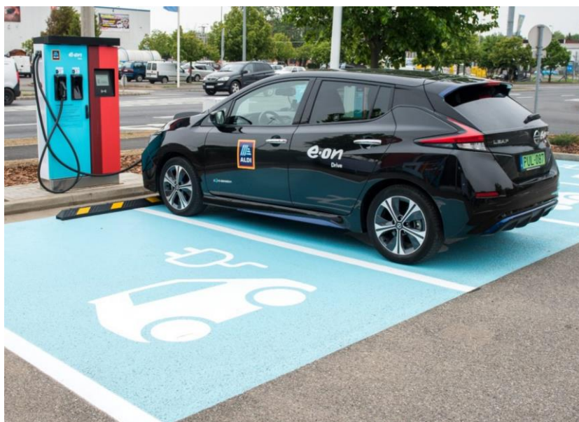
1. sz. kép: Tisztán elektromos meghajtású gépjármű töltése nyilvános töltőhelyen (a rendszámtábla zöld színe utal a tisztán elektromos meghajtási formára)
