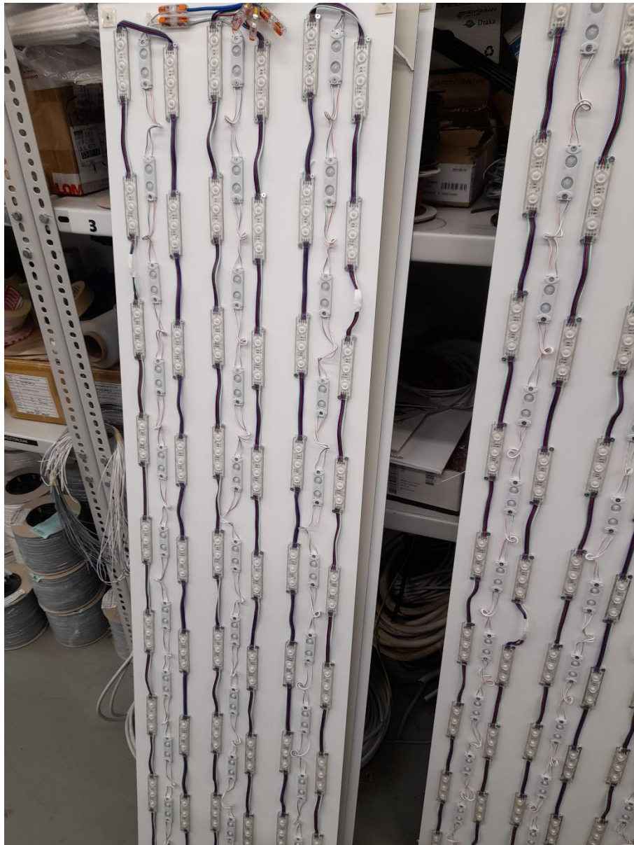
4.1 beépítendő LED panelek
