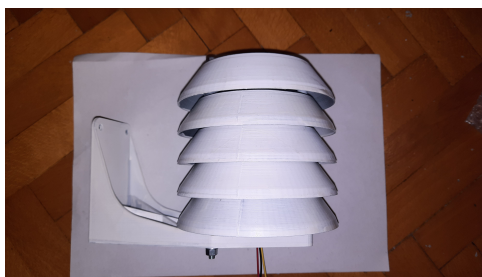
8.9. ábra. A hőmérséklet és páratartalom szenzor árnyékolója
