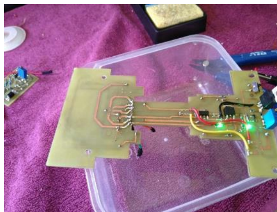
5.3.5. ábra, BMS tesztelése
