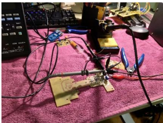
5.3.4. ábra, BMS tesztelése
