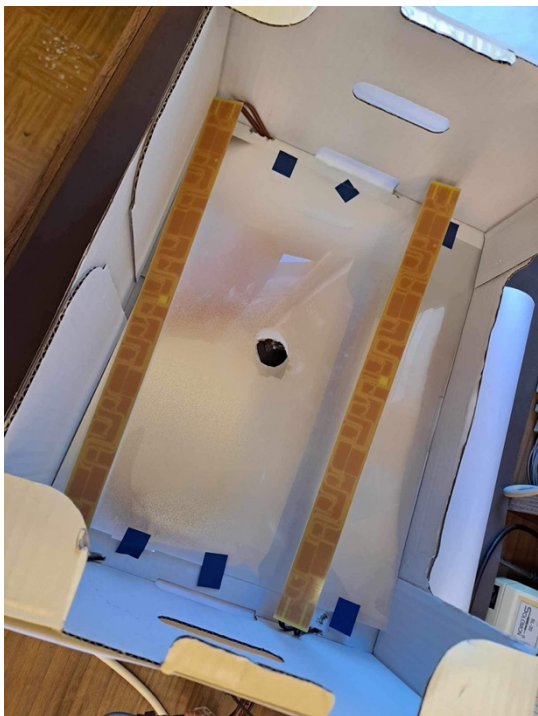
7. Ábra: a diffúzor felragasztott állapotban a megfordított LED panelekkel
