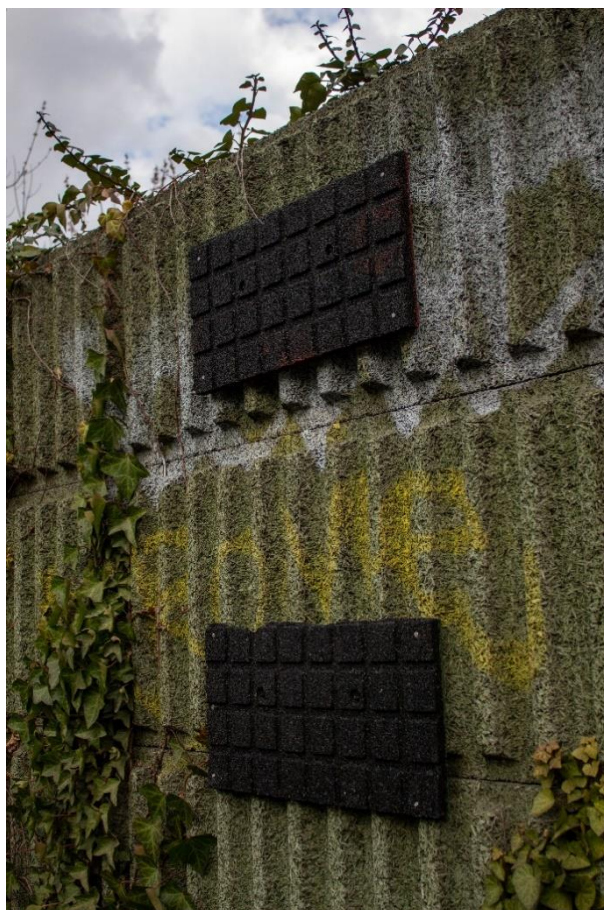
Kihelyezett mintavevő felületek a XII..ker-i Hegyalja úton (saját kép)
