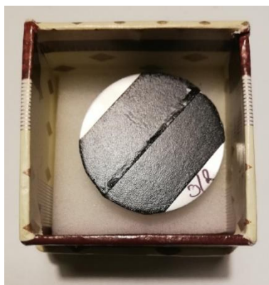
A SEM-EDX méréshez előkészített mintavételi felület a védődobozban (saját kép)
