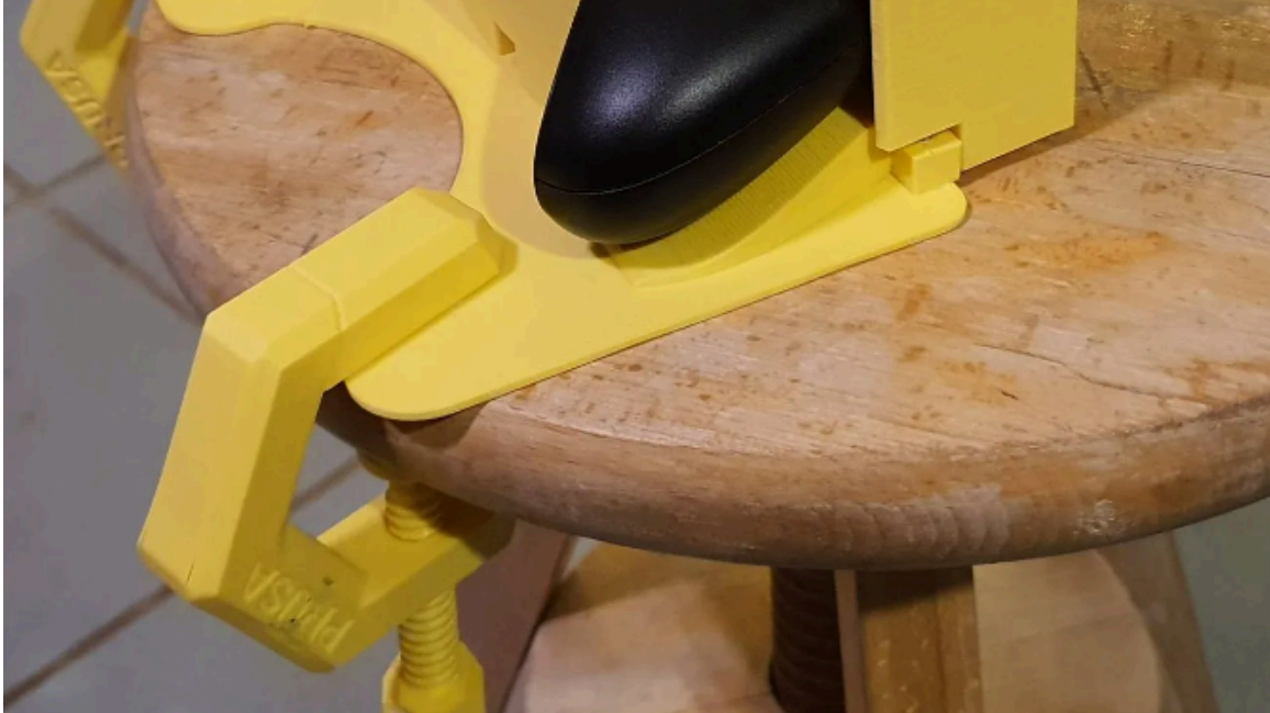
5. ábra: 3D nyomtatott gyorsrögzítő a controller stabilizálásához
