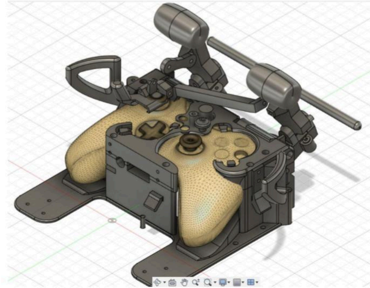
4.B ábra: A második, Leventere adaptált Xbox kontrollert fejlesztés 3D modelje (Fusion 360)
