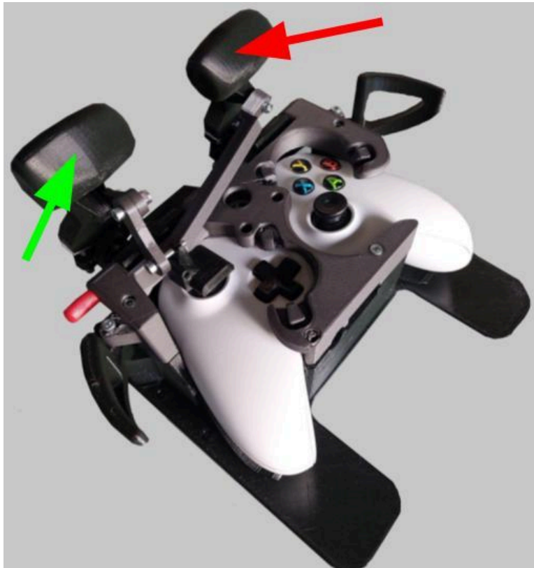
4.A ábra: A második, Leventere adaptált Xbox kontrollert fejlesztés
