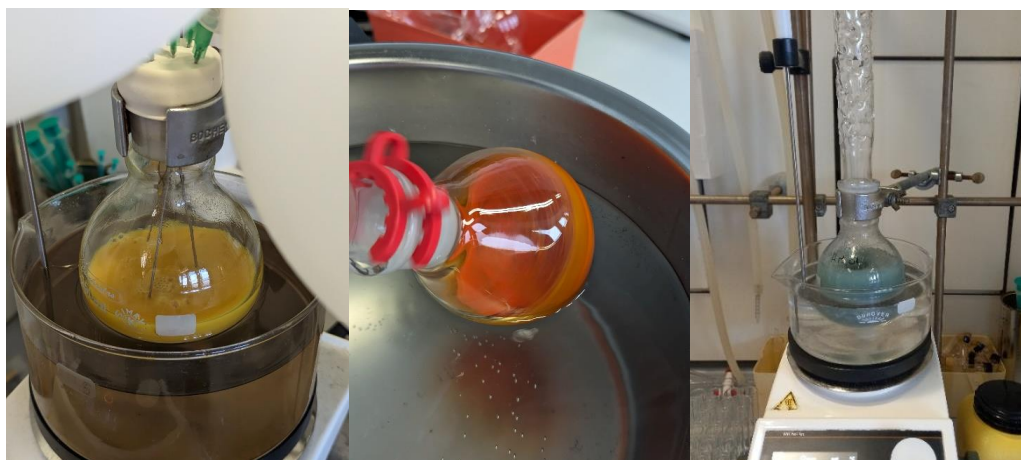
Ezen három kép közül az első a védett fenantrolin oxidációja. Az oxigén gázt lufik és tűk segítségével buborékoltattuk át a folyadékon.
