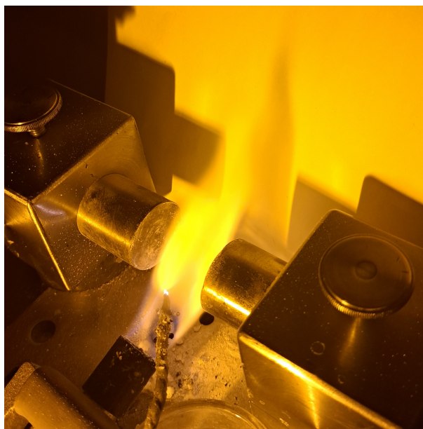
Fig. 1: A jelenség Az árnyék a fehér felületen látszik, míg a két fémszerkezet egy elektromágnes két mágnespóljára.
