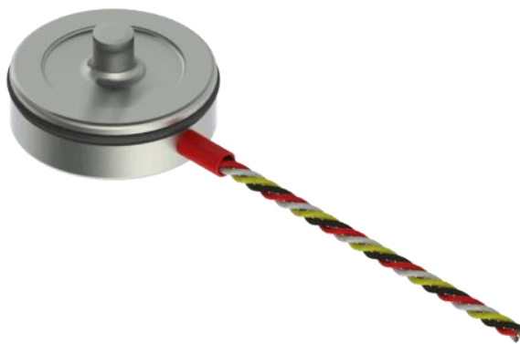
15.ábra: RC15-5 típusú erőmérő cella [4]
