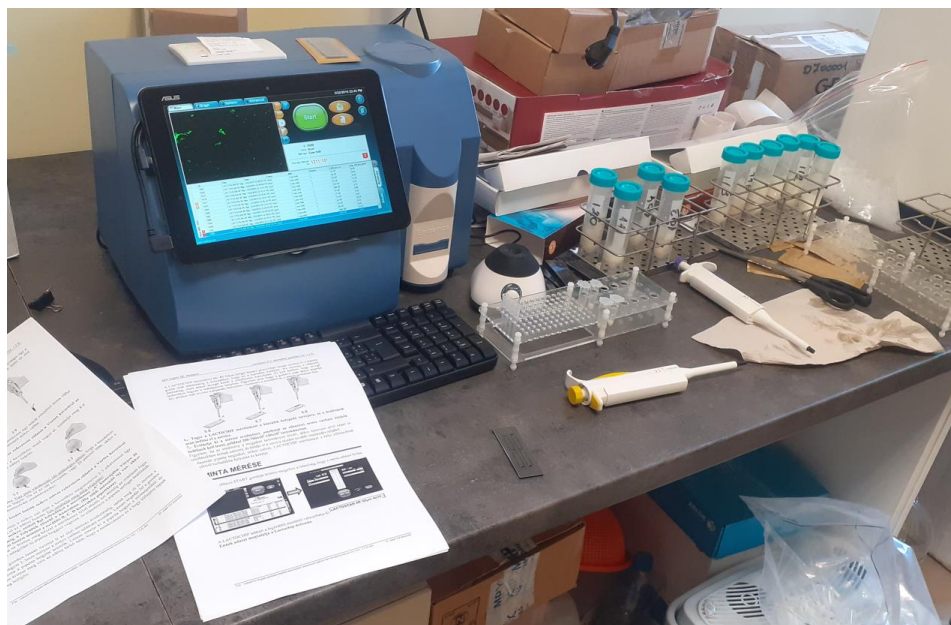
8. kép: LactoScan szomatikus sejt számláló
