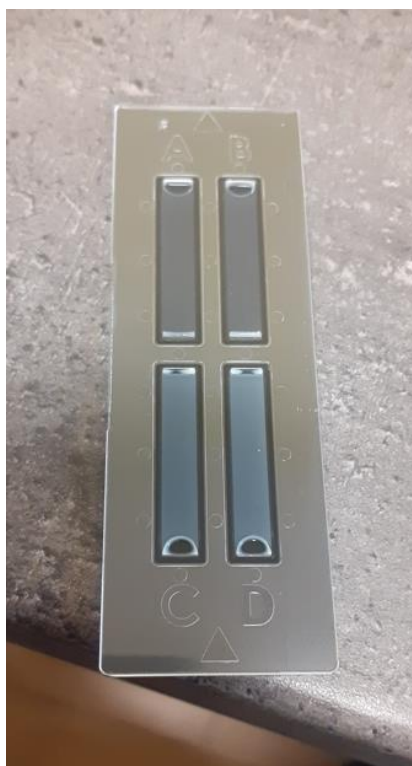
10. kép: Lactochip tárgylemez, benne a végigfutott tejmintákkal
