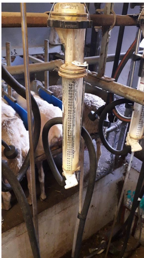
6. kép: TRU-TEST 3,5 kg Sheep Meter
