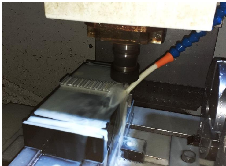
6. ábra: A kavitásokat tartalmazó alkatrészek megmunkálás közben
