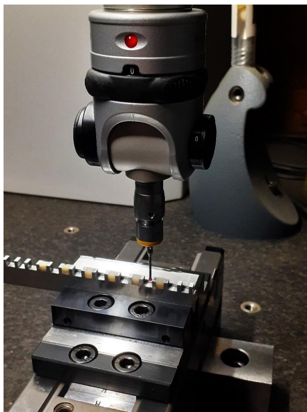
13. Mérések végzése koordináta-mérőgép segítségével
