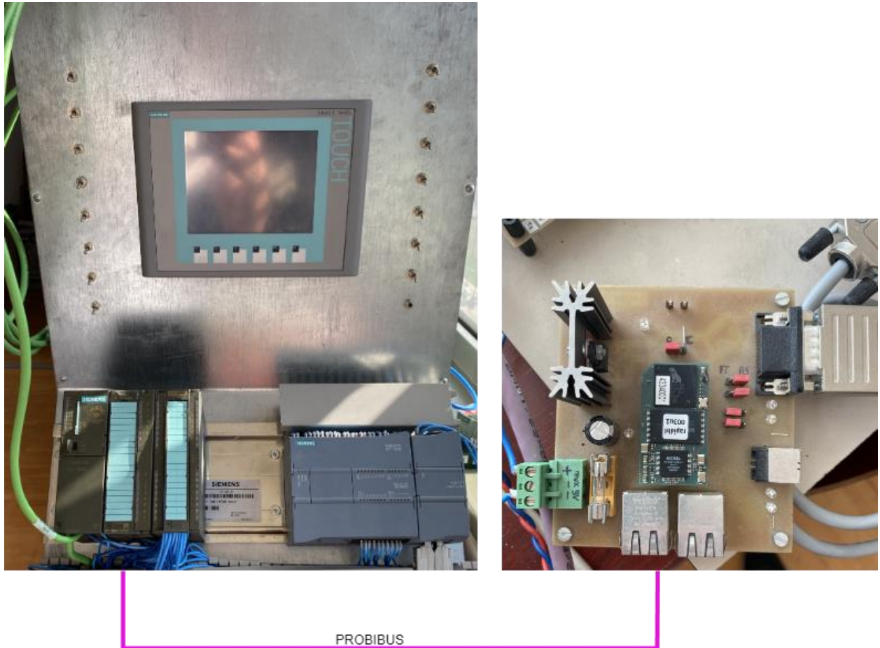
6.1.2 ábra PLC stand és Profibus kommunikációs egység kapcsolása az előírt értékek küldéséhez
