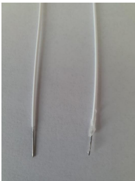
4.1. ábra Injekcióstű kapilláris illesztés, olvadt membrán és tű (bal), viaszbevonat (jobb)
