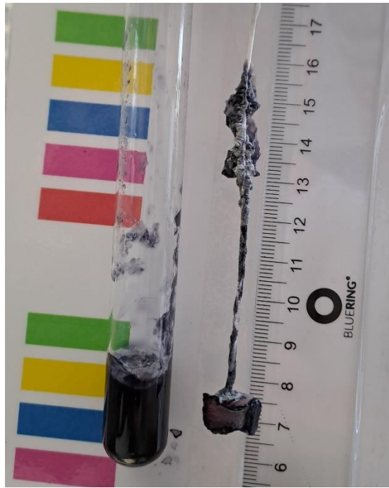
5.1. ábra Biofilm jelenléte a kapillárison és a kémcsőfalán
