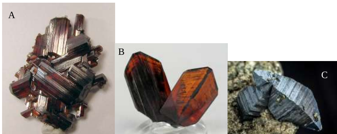
2.2 ábra: A titán-dioxid kristálmódosulatai (A) rutil, (B) brookit, (C) anatáz.
