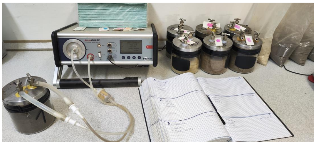
30. ábra: AlphaGuard 2000 hordozható radon monitor mérés közben
