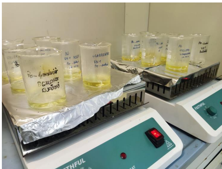
21. ábra: Forrás előkészítés, bepárlási folyamat
