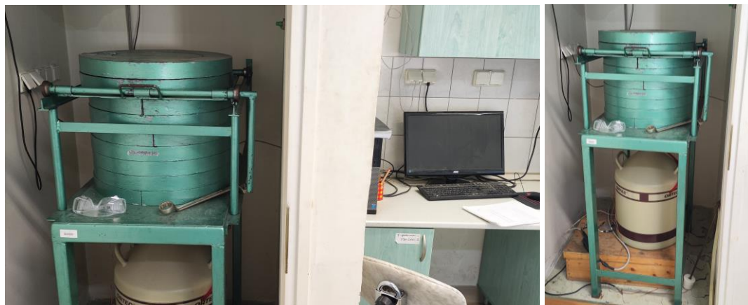
26. ábra: ORTEC HPGe félvezető detektor
