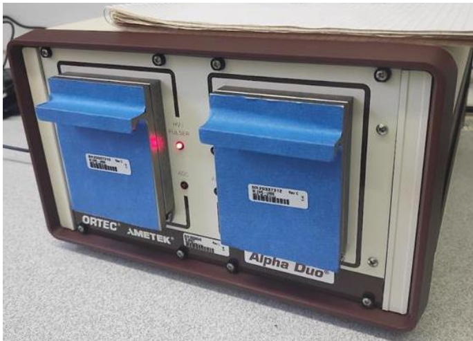
31. ábra: Kétkamrás Ortec Alpha Duo spektrométer, egy minta kamra [12]
