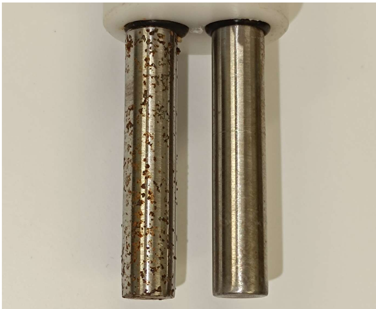
13. ábra. A védett (jobb) és nem védett (bal) elektródok a mérés befejezésekor
