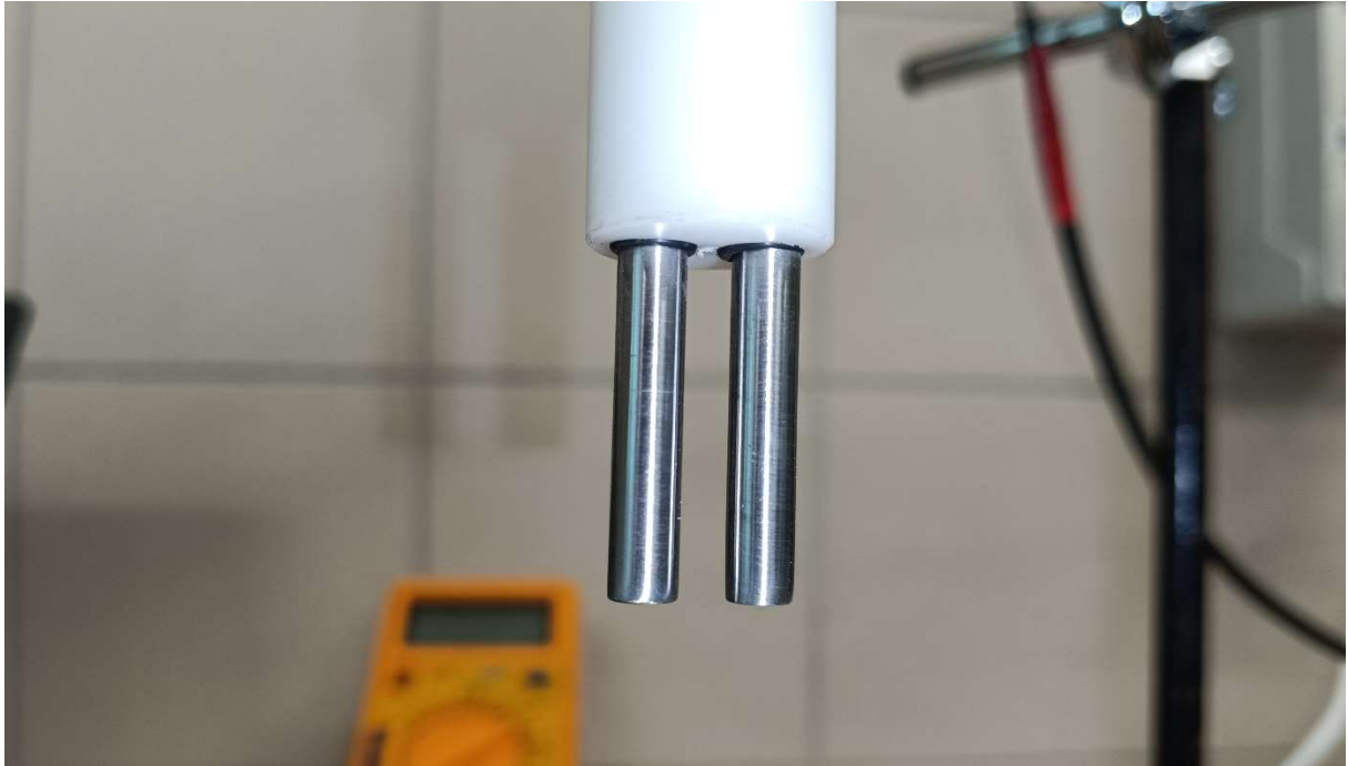
9. ábra. A védett és nem védett elektródok a mérés kezdete előtt
