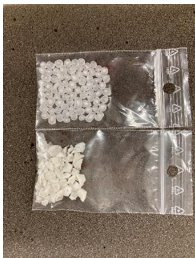
10. ábra: Originális H949A granulátum és hengerszákon homogenizált, majd darált H949A minta
