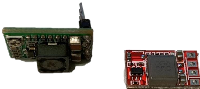
15. ábra: Az általam alkalmazott külső DC-DC konverterek (az eltérő szín ellenére nincs közöttük különbség).
