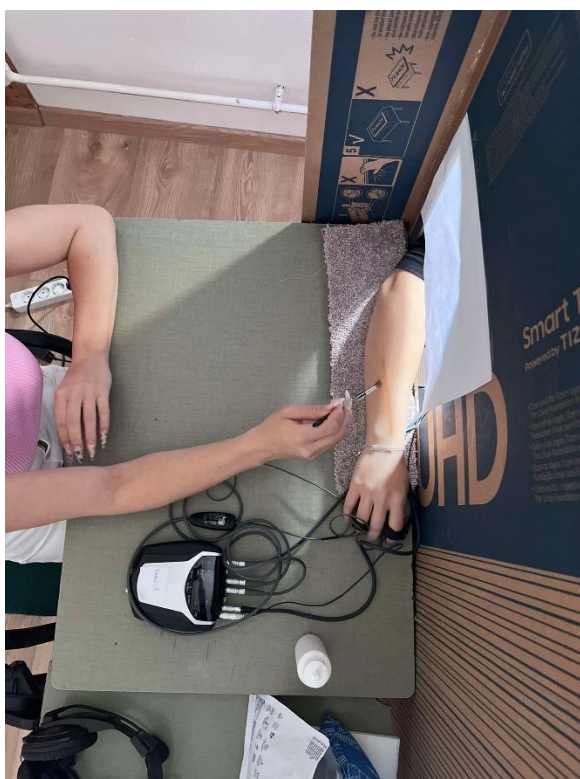
2. ábra: A képen a NeXus rendszer látható mérés közben, valamint a kísérleti személy felelektrodázott karja, amint átnyúlik a választófalon a vizsgálat során.
