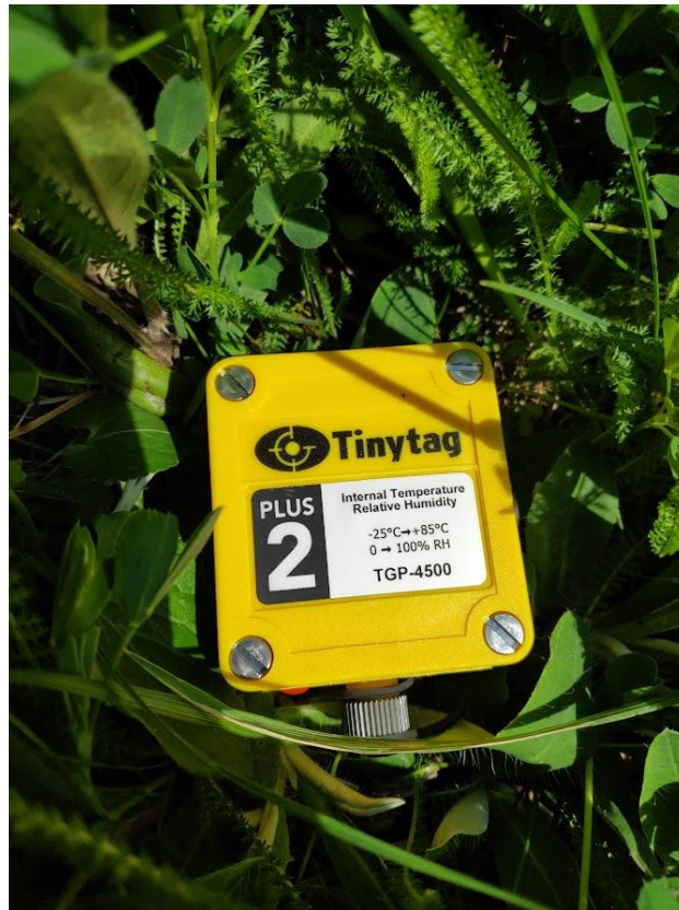
12. ábra Tinytag Plus 2 (TGP 4500) mikroklíma mérő az óbudavári temető gyepében
