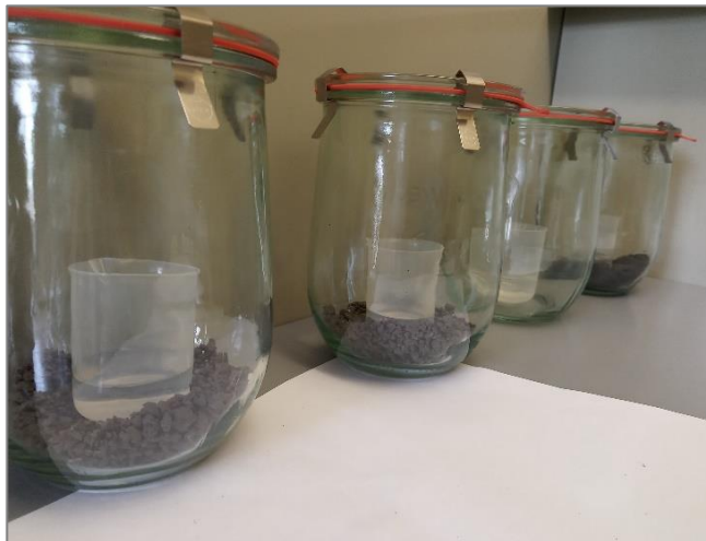
10. ábra: A BSR méréshez összekészített minták és NaOH a légmentesen zárható üvegekben (Fotó: a szerző képe)
