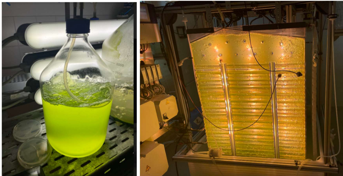
3. ábra: Laboratóriumi fotobioreaktor (bal) és paneles kialakítású fotobioreaktor (jobb) (saját fénykép, Albitech Kft., Budapest)
