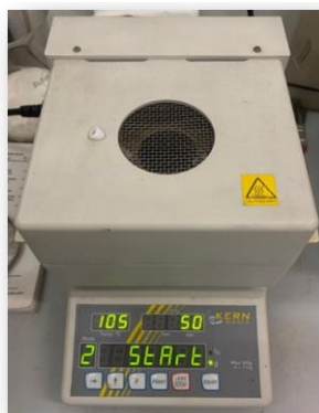
13. ábra A nedvességtartalom mérés műszere, a Kern MLB 50-3 készüléke (Forrás: Saját szerkesztés)
