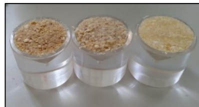
8. ábra: 1., 2. és 3. masszák kenhetőségi vizsgálatra előkészítve
