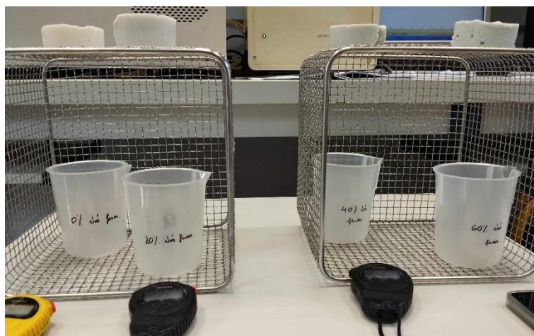
6. ábra: Az olvadékonysági tesztek elvégzéséhez szükséges eszközök elrendezése
