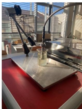
16. ábra Vezetőképesség mérése mézsör mintán (saját felvétel)
