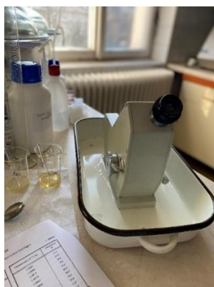
8. ábra RL-3 típusú Abbe-féle refraktométert (saját felvétel)
