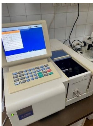
15. ábra HITACHI U-2900 UV/ VIS spektrofotométer (saját felvétel)
