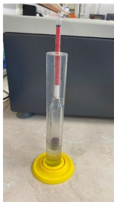
12. ábra Relatív sűrűség mérése areométerrel (saját felvétel)
