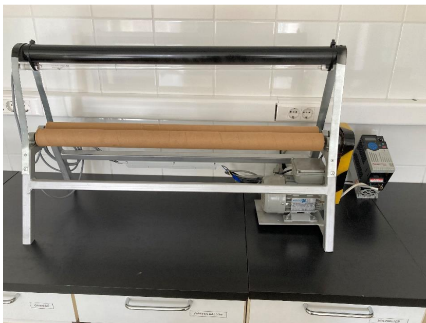
4. ábra UV-C fénycsöves épített berendezés (saját kép)
