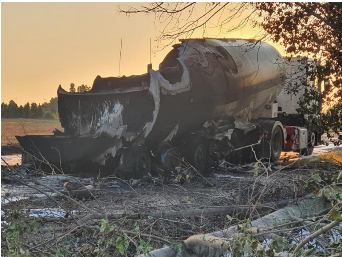
25. ábra: A tartány hátsó négy rekesze teljesen megsemmisült (saját készítésű fotó)
